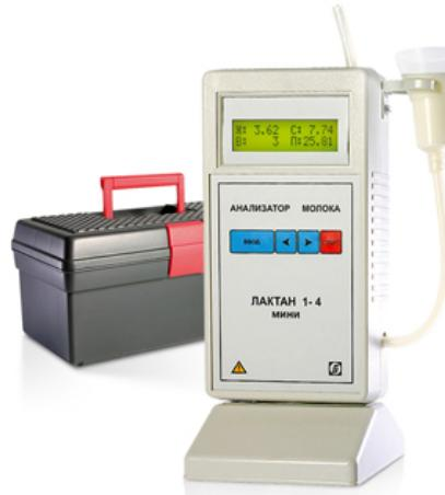
Ультразвуковой индикатор «Лактан 1-4М» исп. Мини определяет **массовую долю жира, СОМО, добавленную воду и плотность** в пробе сырого коровьего молока. Среднее время измерения составляет **3 минуты**, это в 2 раза быстрее, чем при использовании традиционного метода анализа, безопасней, экономичней и проще. Точность определения параметров качества молока при этом полностью соответствует требованиям стандартных методов.
