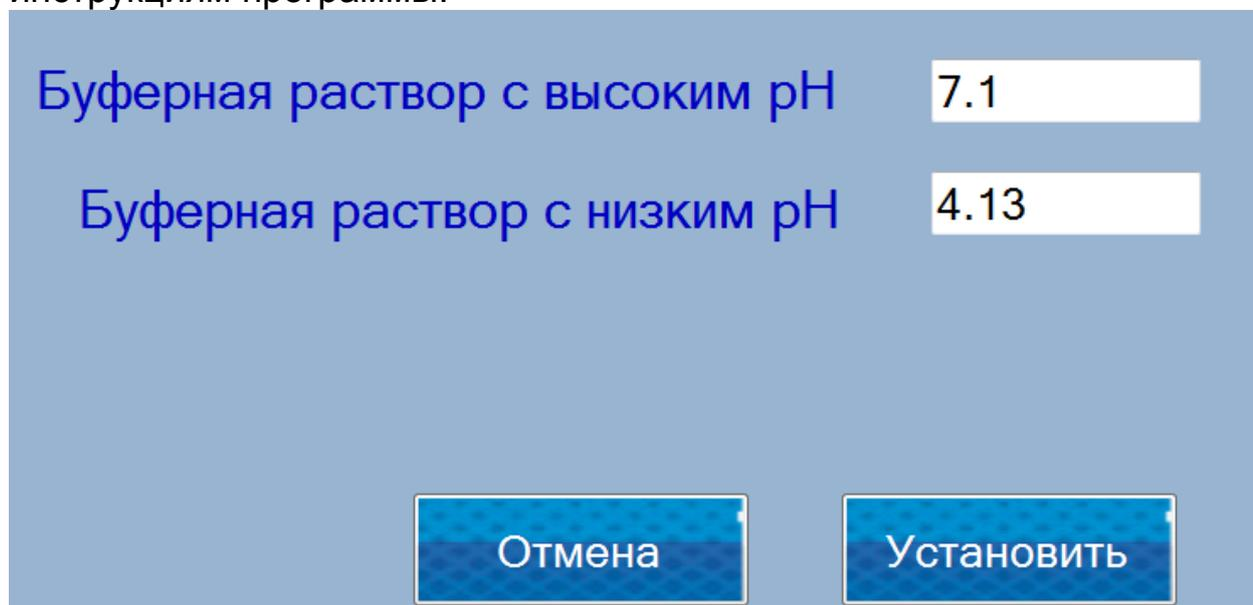
Оператор вводит значения буферов, используемых для калибровки. Выбор буферов и принципов работы с рН-метром описаны в документе WLS-TechManual. При нажатии на кнопку Set для перехода к фактической калибровке. Отчеты этого процесса отображаются в
