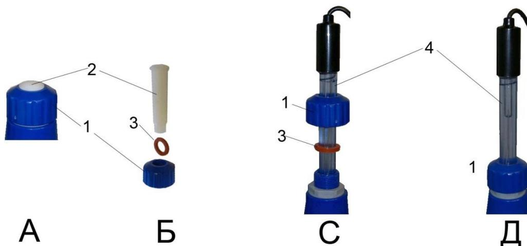
1. Ослабить гайку против часовой стрелки
