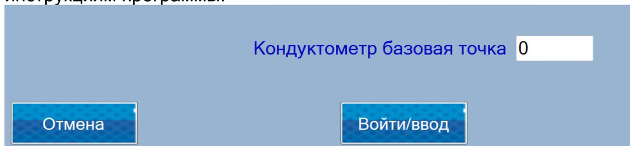
Оператор вводит значения буфера, который будет использоваться для калибровки. Выбор буфера и принципов работы с системой для измерения проводимости, описаны в документе ВНК-TechManual. При нажатии Enter введите ключ для актуальной калибровки измерительной системы. Отчеты этого процесса отображаются в System Status, в правом верхнем углу экрана. При нажатии на кнопку Отмена, процедура завершается и передается на главный экран.
