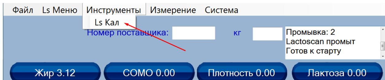
Открывается программный инструмент для калибровки. Оператор выбирает СОМ-порт, и нажимает кнопку Start. После этого вводит значения параметров в полях. С помощью кнопки - Измерение, начинается новое измерение образца в режиме калибровки.
